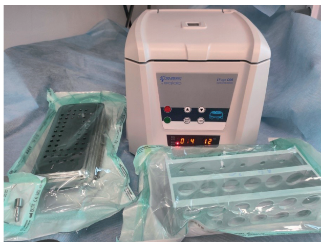
Ryc. 3. Przykładowa wirówka laboratoryjna ze stojakiem na próbki i kasetą do uzyskania A-PRF.
